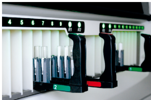
Zone de chargement pour 180 échantillons et 28 flacons de réactifs
