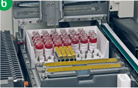
Reagenzienlagerungs- und Pipettierbereich
