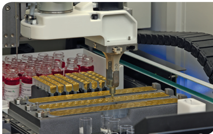
Perçage des racks ID-Diluent
